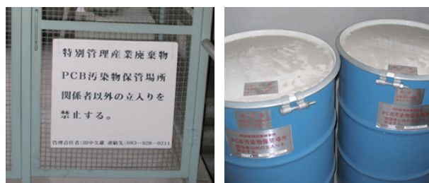
PCB 含有廃棄物の適正保管
