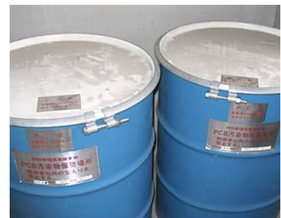
PCB 含有廃棄物の適正保管
